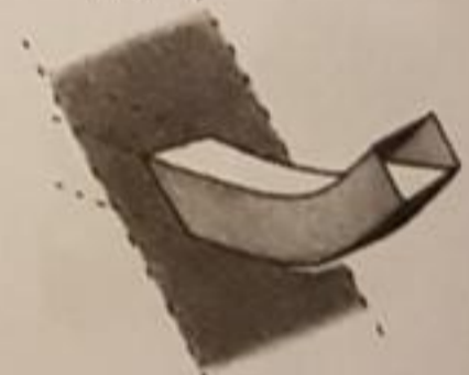
بیرون‌زدگی بلندشده erectile cantilever
