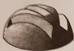
گنبد شیاری trenched dome
