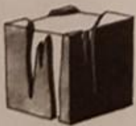
نورگیر چکه‌کننده dripping skylight
