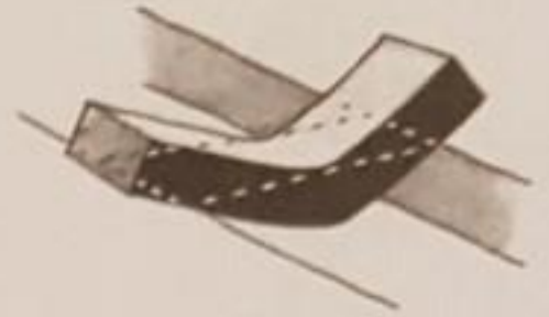
پل خیزدار sag bridge
