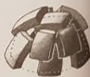
گنبد تعادلی ballast dome
