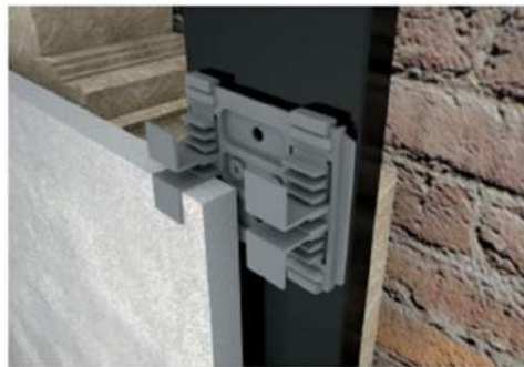
شکل ۷-۲۱- سیستم نصب نمایان
