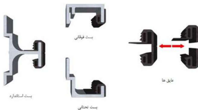
شکل ۷-۱۱- نصب درزپوش بر روی بست‌ها
